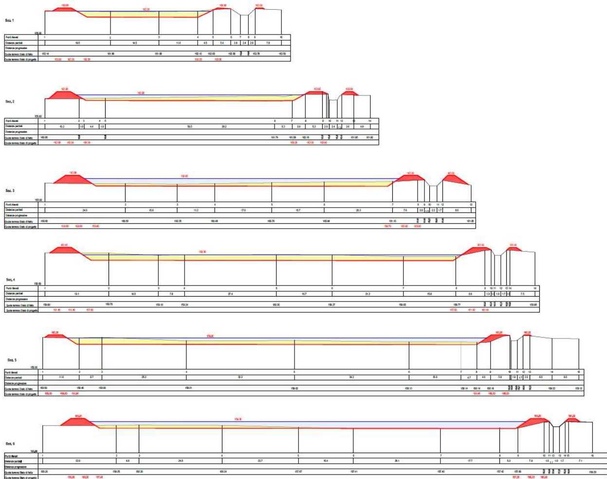
FIGURA 26: SEZIONI DI PROGETTO, CHE EVIDENZIANO GLI SCAVI E I RIPORTI DI TERRENO. SI NOTA ANCHE L'INNALZAMENTO DEGLI ARGINI DEL RIO ENZOLA [RIDUZIONE DALLA SCALA 1:250]
