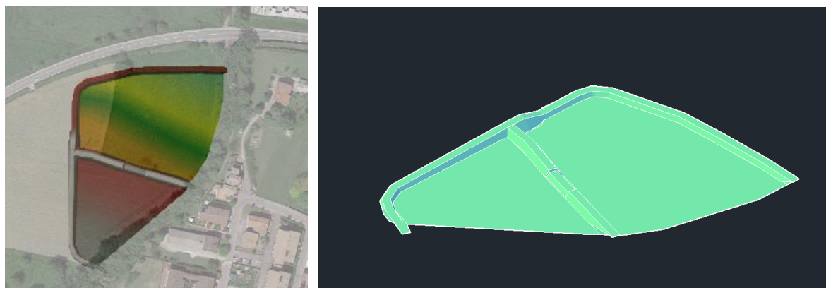
FIGURA 5-1 – RIO ENZOLA, MODELLO DIGITALE DEL TERRENO DELLE CASSE D'ESPANSIONE
