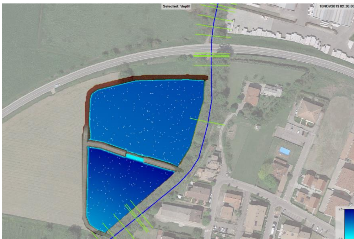
FIGURA 5-17 – MAPPA DI ALLAGAMENTO DELLE CASSE: SITUAZIONE AL MINUTO 150
