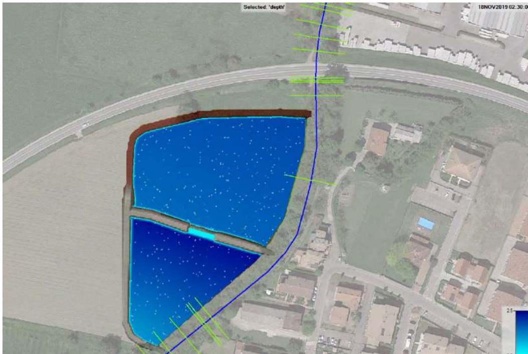
Figura 5-17 – Mappa di allagamento delle casse: situazione al minuto 150 (le frecce bianche indicano la direzione del flusso idrico e la velocità)
