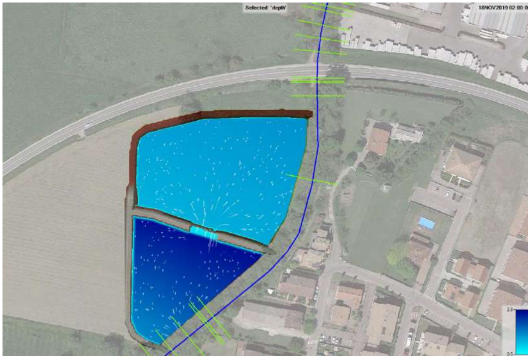
Figura 5-16 – Mappa di allagamento delle casse: situazione al minuto 120 (le frecce bianche indicano la direzione del flusso idrico e la velocità)
