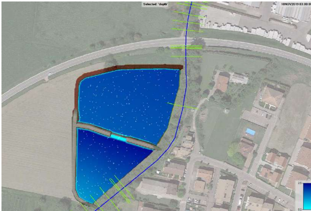
Figura 5-18 – Mappa di allagamento delle casse: situazione al minuto 180 (le frecce bianche indicano la direzione del flusso idrico e la velocità)
