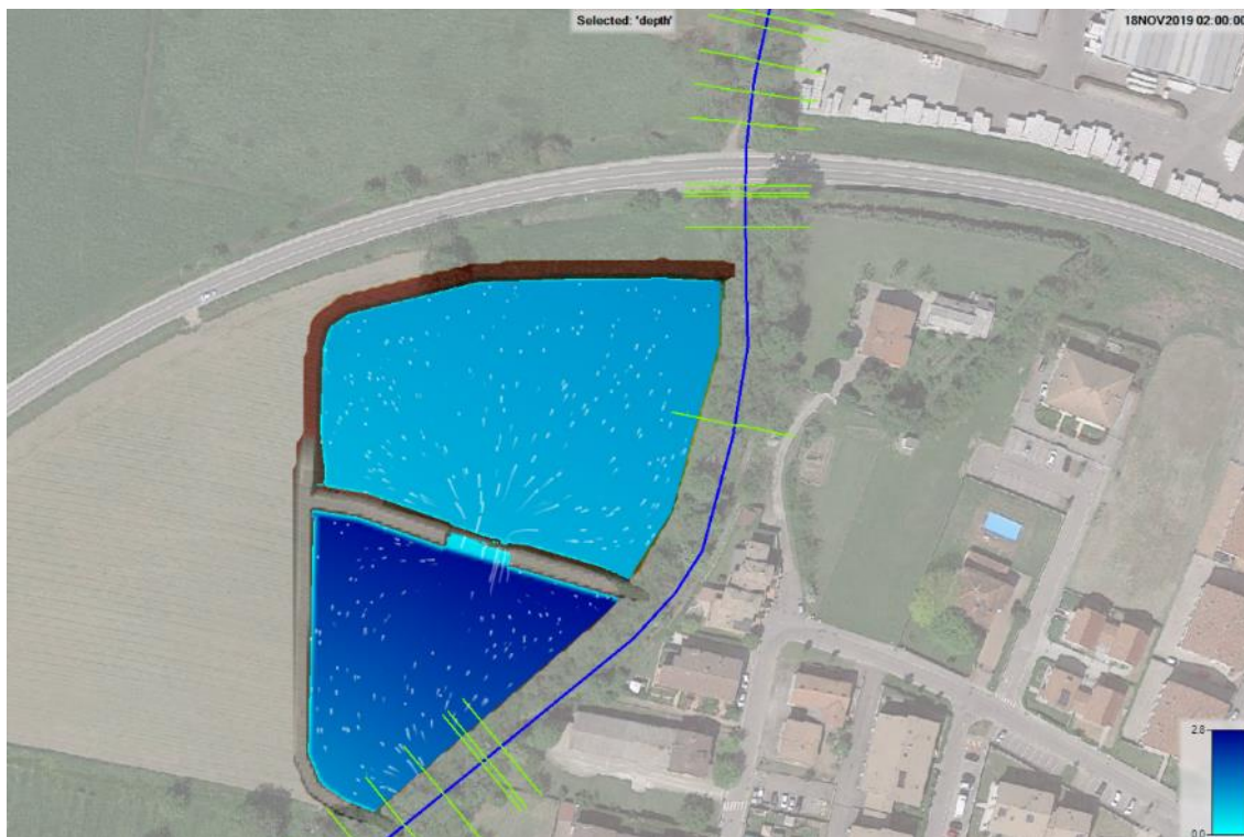
FIGURA 5-16 – MAPPA DI ALLAGAMENTO DELLE CASSE: SITUAZIONE AL MINUTO 120
