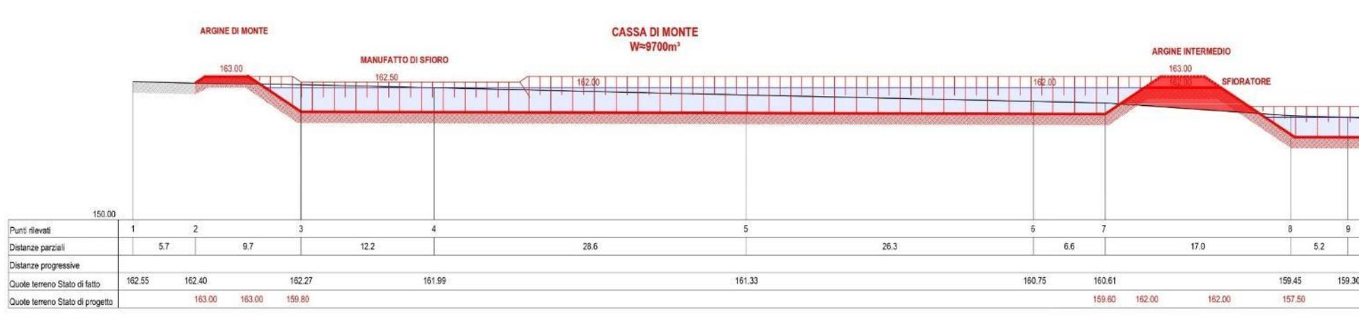
**FIGURA 5-2 – RIO ENZOLA, CASSA DI LAMINAZIONE DI MONTE: PROFILO LONGITUDINALE**
