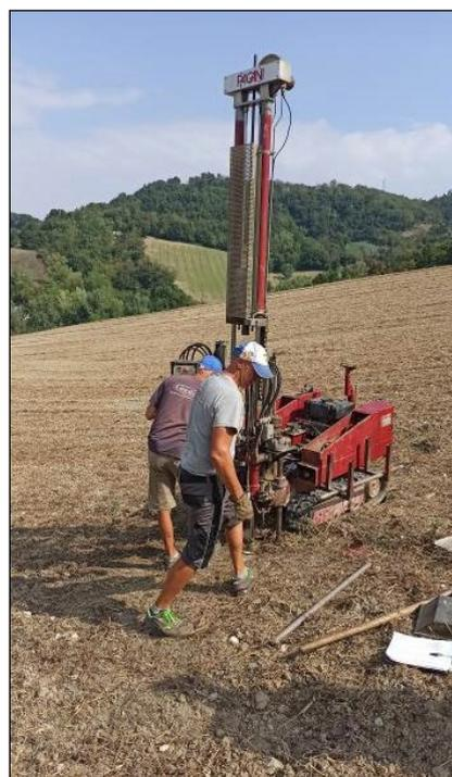
Figura 6: prova penetrometrica statica.
