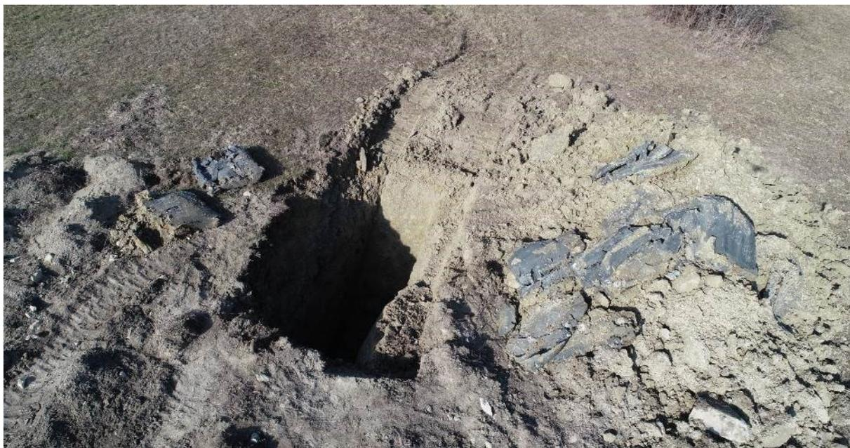
Figura 7: prelievo campione per analisi delle terre.
