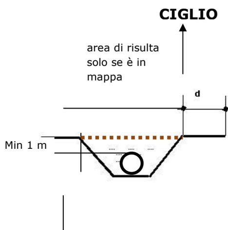
In caso di tombinamento preesistente, in cui non è possibile stabilire la posizione del ciglio precedente, si può fissare il ciglio a 0,5 m dall'esterno tubo al fine di calcolare le distanze di rispetto dei fabbricati.
