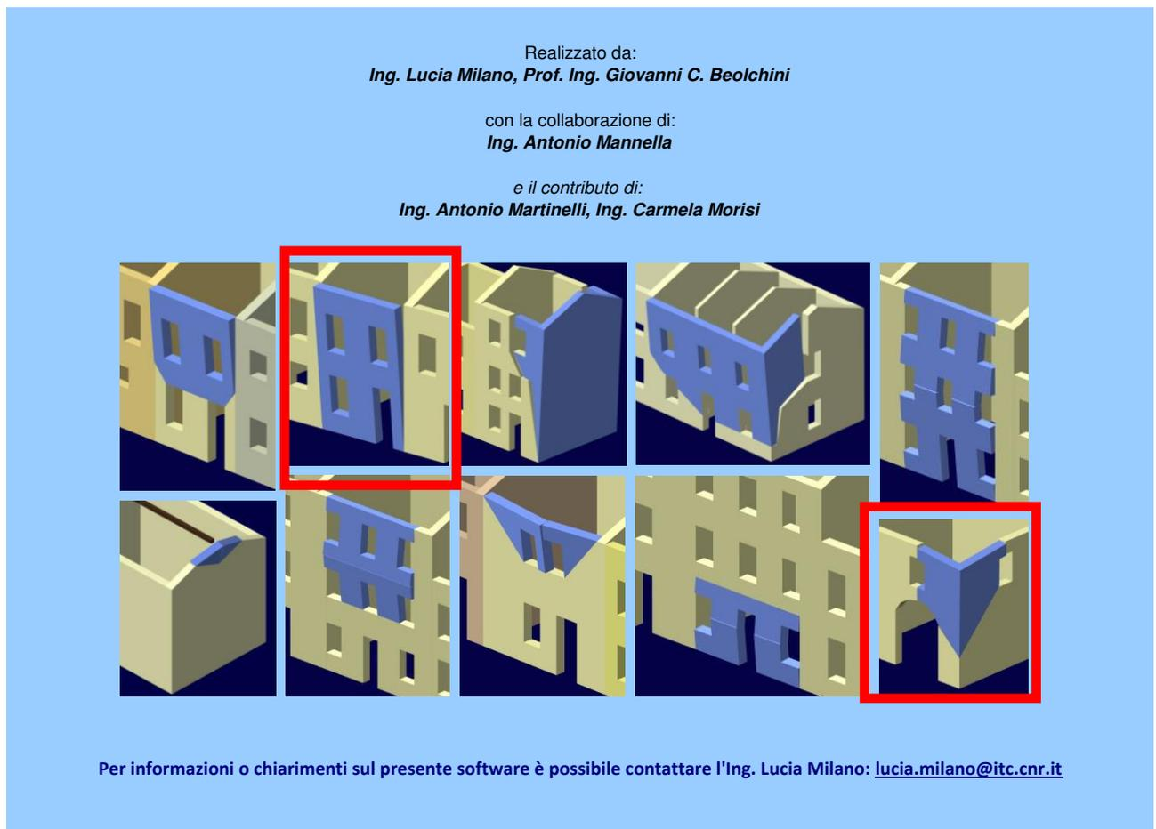
Si analizza la minima accelerazione che innesca i seguenti meccanismi di collasso:
